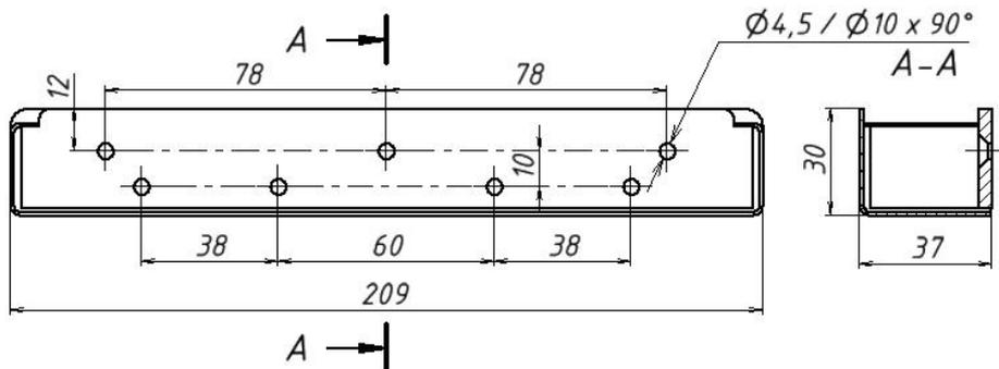
Рисунок 2 – Габаритно-установочные размеры комплекта МК 700S
