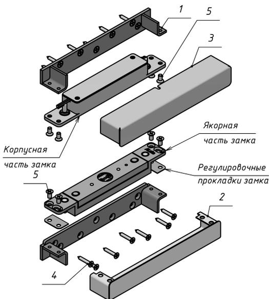
Рисунок 1 – Установка замка ALM-700S с комплектом МК 700S
